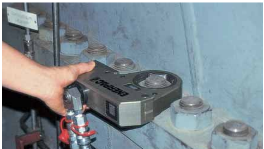
Sechskantdrehmomentschlüssel. Der geringe Kopfradius und die Schwenkkupplungen erlauben einen problemlosen Zugang in allen Positionen.
